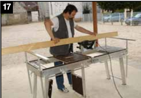
Un rabot mis en stationnaire sur son berceau fixé sur un plateau posé entre les martyrs et les servantes devient une mini dégauchisseuse.
