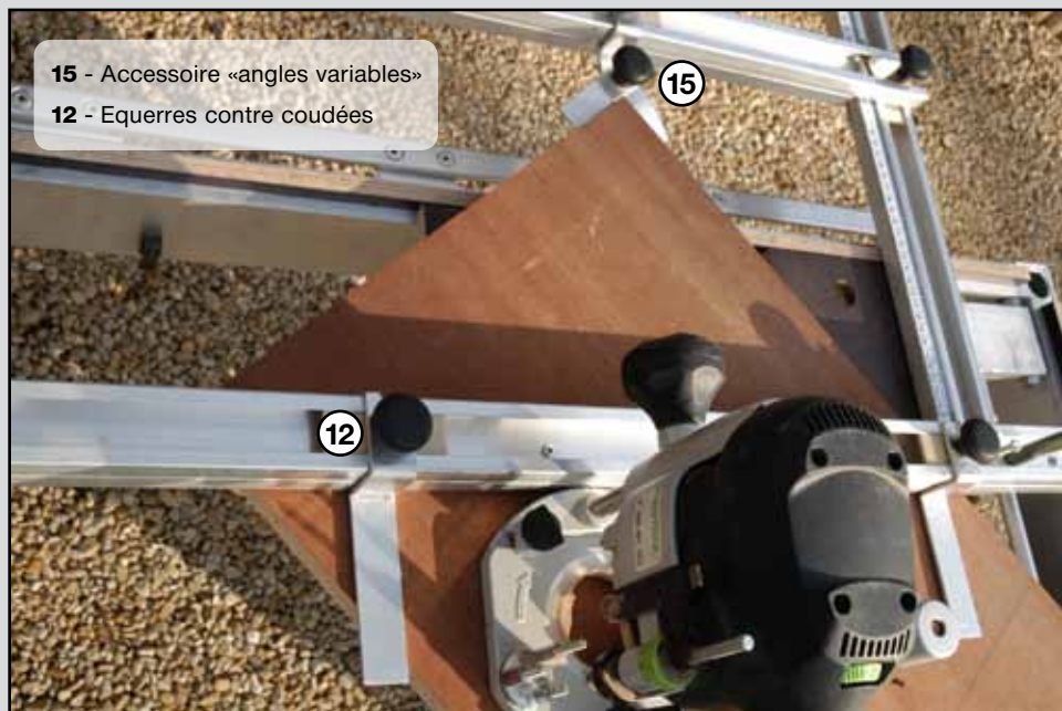
GUIDE COUPE travail en angle et en limitation de course à la défonceuse
