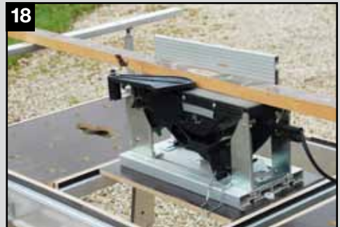
Un rabot mis en stationnaire sur son berceau fixé sur un plateau posé entre les martyrs et les servantes devient une mini dégauchisseuse.
