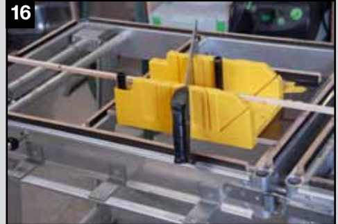
Mise en place rapide d'une boîte à onglet montée sur un plateau
