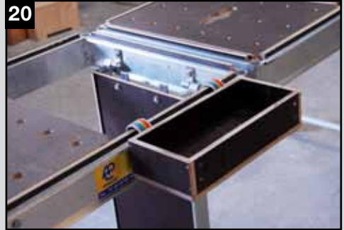
20 Une boîte à outils, à clou, à vis dégage le plan de travail, évite des chutes
