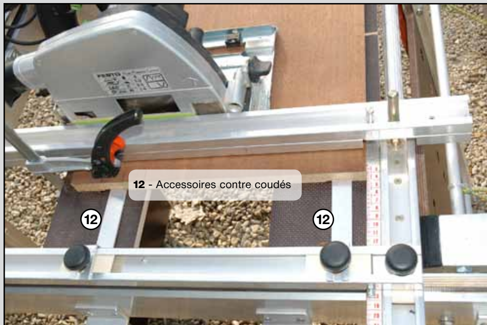
GUIDE COUPE et EQUERRES CONTRE COUDEES coupe de petite largeur à la scie circulaire
